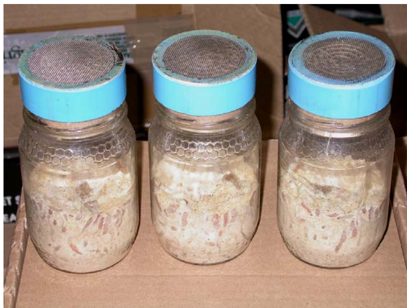
Fig. 3.2.3.1. Teelflesse met riffelkartonproppe – 'n blou PVC-dop met vleklosestaal-gaasdraad beskerm die kartonprop.
