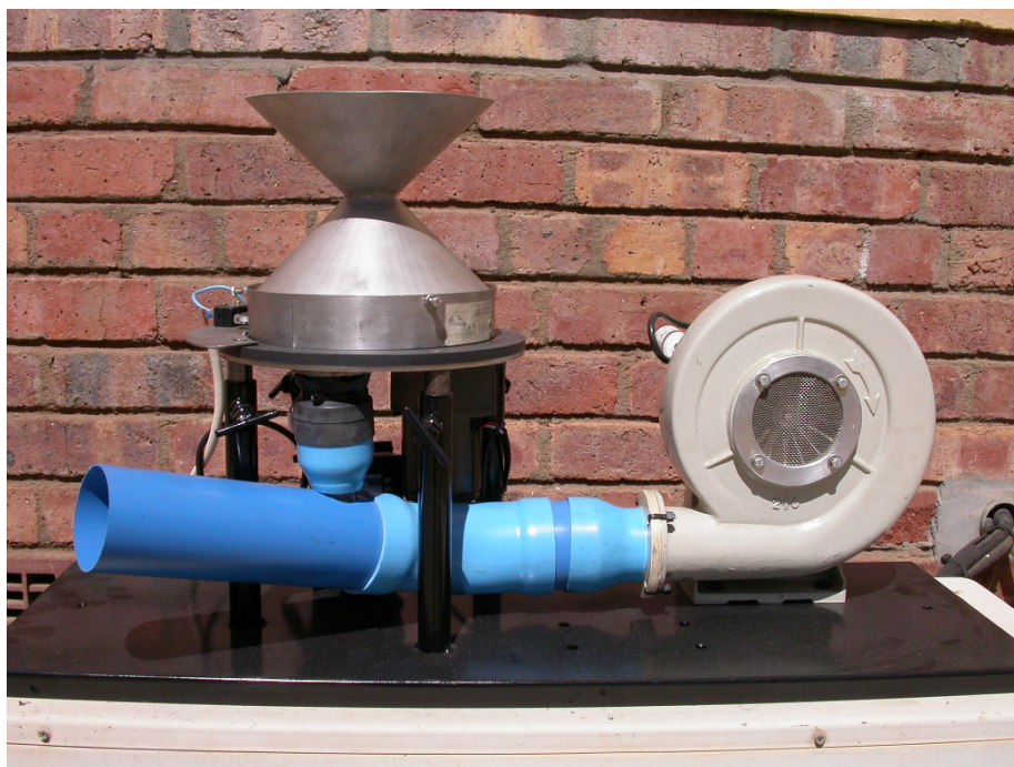
Fig. 3.2.3.17. 'n Apparaat vir die loslaat van gesteriliseerde valskodlingmot in sitrusboorde. Die toerusting word op 'n vierwielmotorfiets vasgebout.
