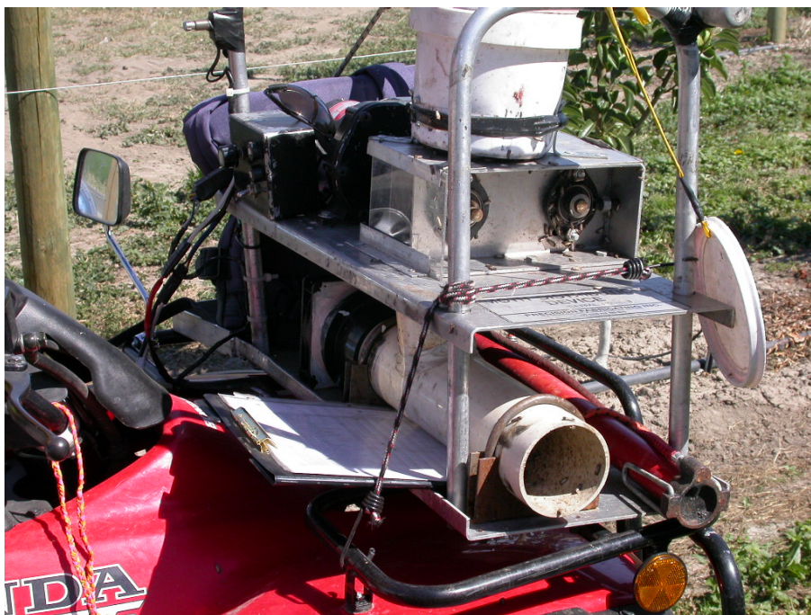
Fig. 3.2.3.16. Motloslaattoerusting op 'n vierwielmotorfiets gemonteer wat vir die loslaat van Kodlingmot in Kanadese appelboorde gebruik word.
