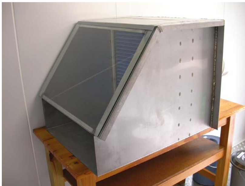
Fig. 3.2.3.3. Lugsuiweringskas waarin koue-geïmmobiliseerde valskodlingmot hanteer is. 'n Deel van 'n aksiale suigwaaier, wat lug van voor na agter deur 'n filtreerder in die kabinet gesuig het, is aan die agterkant sigbaar.
